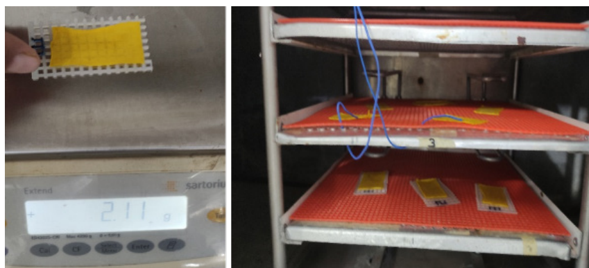
Figura 3. Pesado y disposición de las muestras en las bandejas del túnel.
